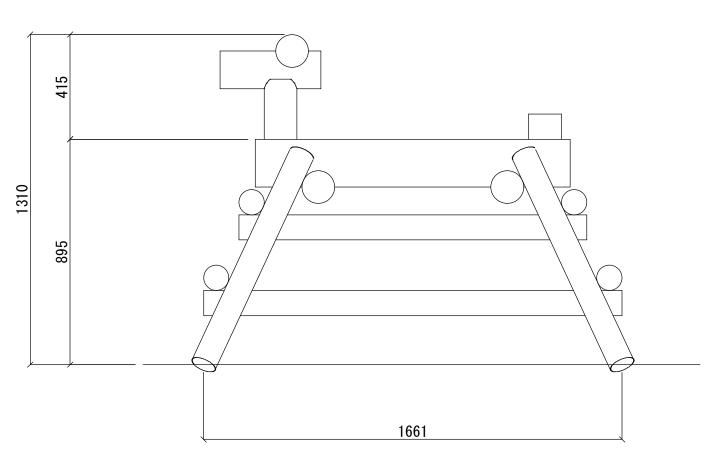
防腐加工 マイトロールACQ加圧注入処理 ステンレス  $\phi$  12ボルト、ロックナット使用 据え置き式 (基礎工事不要)
